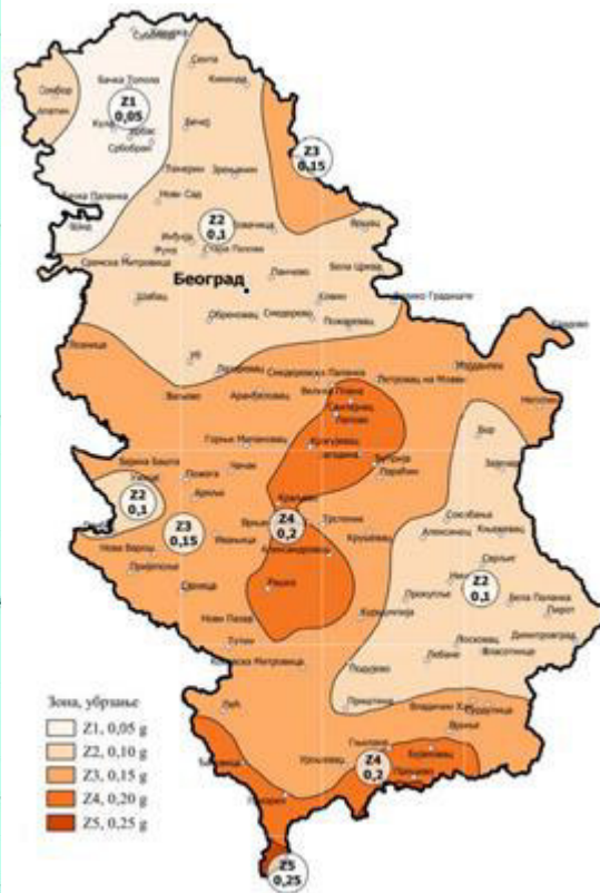
Slika 2. Karta seizmičkog hazarda Republike Srbije izrađena u stepenima makroseizmičkog intenziteta (levo) i u jedinicama horizontalnog ubrzanja (desno) za povratni period od 475 godina (SRPS EN 1998-1/NA;2018).
