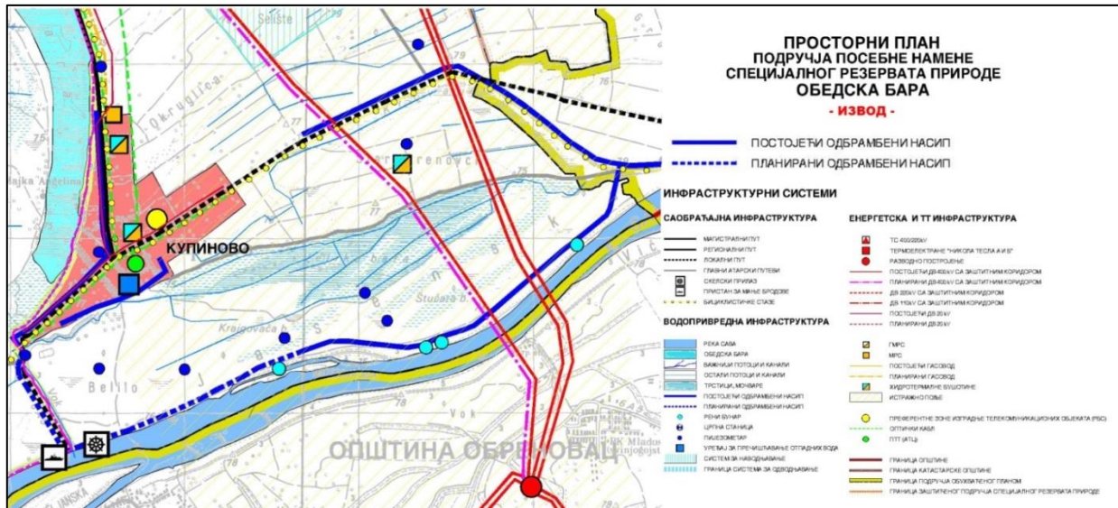
Слика 1: Извод из ПППН СРП Обедска бара - На слици су са плавом бојом приказани постојећи насипи, а са испрекиданом плавом бојом планирани насипи
